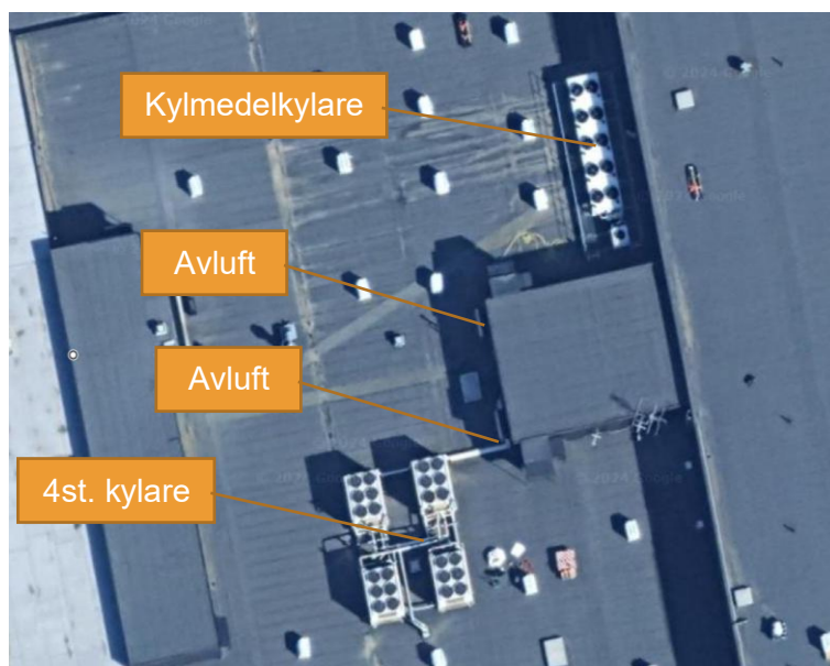
Figur 3. Inmätta bullerkällor på Planiahusets tak.
